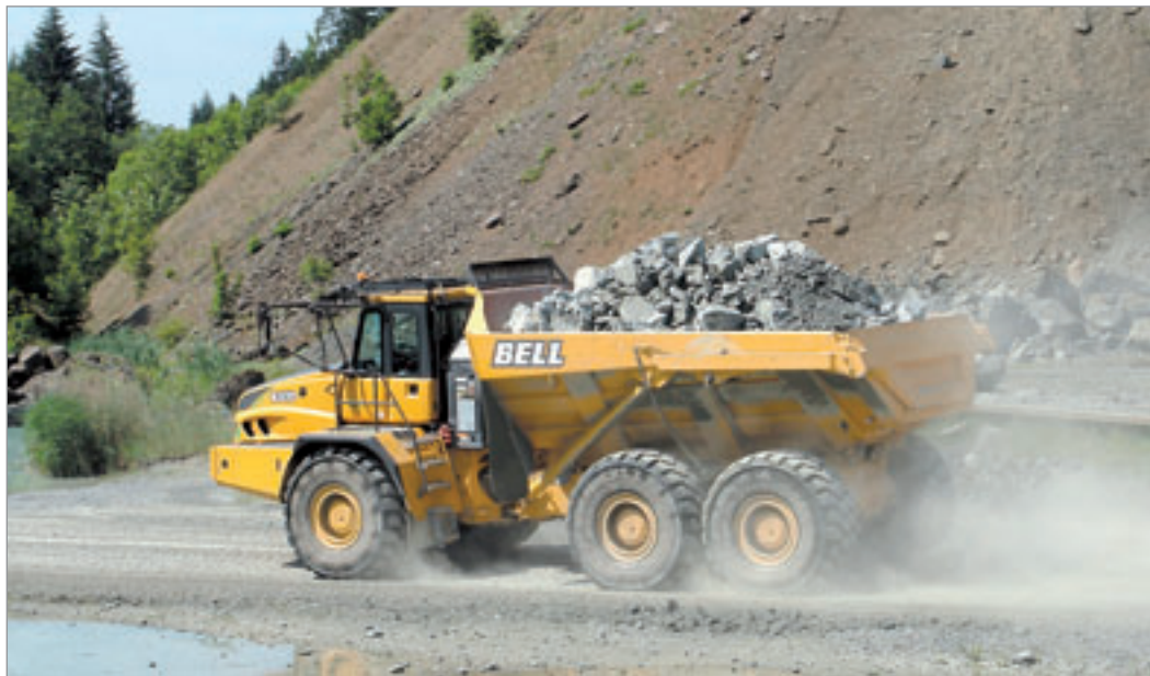
Bell B50D on järein ja viimeksi eli vuonna 2004 sarjaan esitelty malli. Sen kantavuus on jo 45,4 tonnia ja Mersun moottori antaa kiven kyyditykseen lähes 400 kilowatin tehon.
